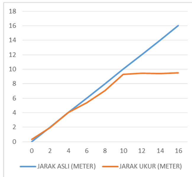
Gambar 10: Perbandingan rata-rata dari 30 pengukuran jarak dengan jarak asli
