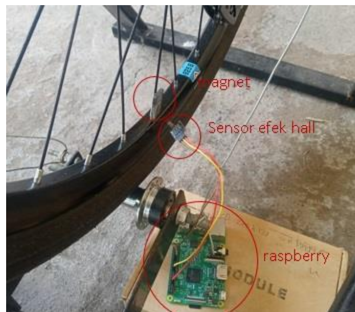
Gambar 6: Raspberry Pi 3, Sensor Efek Hall, dan Magnet
